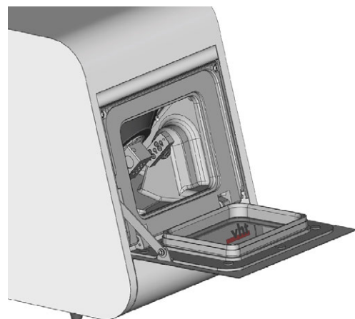
FIG. 3 SPORTELLO DEL VANO DI LAVORO
