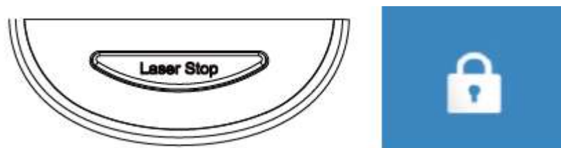
Figura 26 Buton de oprire de urgență „Laser Stop” și butonul de blocare a aparatului
